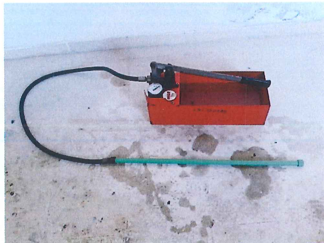
Figura 2. Resistencia a la presión interna.
